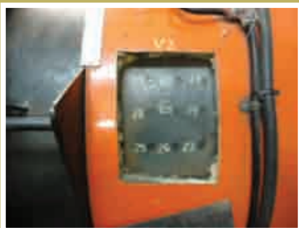
Figura 6: detalle de la ventana con los puntos de medición identificados.
